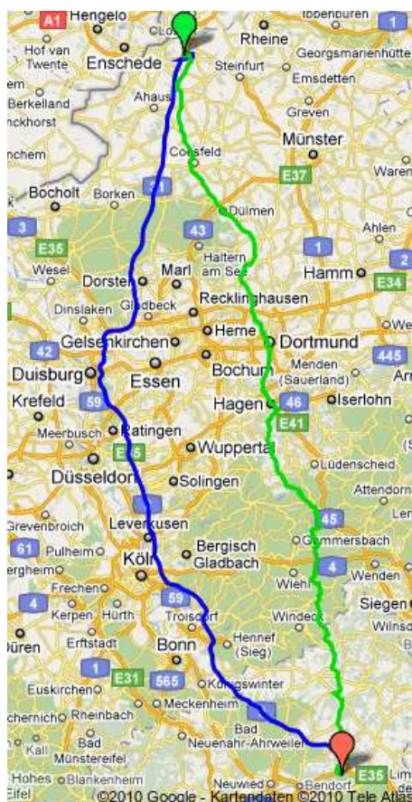
Abbildung 4.4: Zwei unterschiedliche Routen aus der Umgebung von Enschede zu einem Ort nordwestlich von Koblenz. Die optimale Route nach dem Modell mit einheitlichem Verbrauch für alle Network Classes (blau) führt über diverse Autobahnen. Die nach differenziertem Verbrauch (grün) optimierte Route verläuft relativ direkt über Land- und Bundesstraßen. Als Stundenlohn wird in diesem Beispiel 1 Euro angesetzt.
