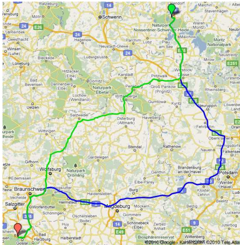
Abbildung 4.13: Anfrage, die von der Mecklenburger Seenplatte zu einem Ort südlich von Braunschweig führt. Durch eine explizite Optimierung nach dem verbrauchsbasierten Modell mit differenzierten Verbrauchswerten (grün) werden 2,04€ gespart. Die zurückgelegte Distanz ist um 80 km kürzer als die der Route nach dem Modell mit einheitlichem Verbrauchswert (blau). Auf der anderen Seite müssen aber 40 Minuten mehr Fahrtzeit investiert werden.
