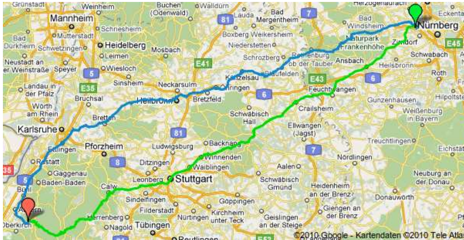
Abbildung 4.6: Aus der Nähe von Nürnberg in den Westen des Schwarzwalds. Die Route ohne Berücksichtigung von Höheninformationen (grün) führt mitten durch den Schwarzwald. Werden Steigungen und Gefälle bei der Optimierung mit einberechnet (hellblau), dann verläuft der Fahrtweg am westlichen und nördlichen Rand des Schwarzwalds entlang. In diesem Beispiel wird ausschließlich nach Energieverbrauch optimiert, was einem Stundenlohn von 0€ entspricht.
